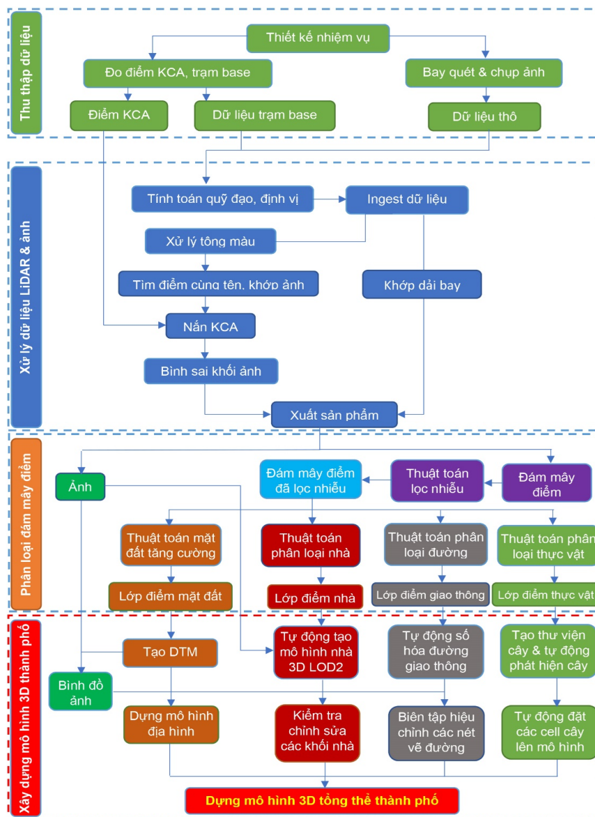
Hình 2. Quy trình chi tiết thu nhận, xử lý và phân loại dữ liệu LiDAR phục vụ thành lập mô hình 3D thành phố.
